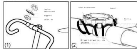
Utiliser les élastiques pour fixer le support au guidon ou à la colonne avec les élastiques.
