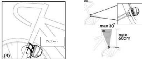
Monter le capteur avec les languettes de nylon sur la fourche avant, du côté que l'on préfère.
