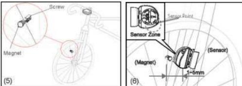
Au moyen d'une vis, fixer l'aimant de détection de la vitesse sur un rayon de la roue avant.
