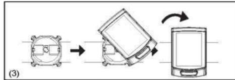
Placer le cyclo-ordinateur sur le support et le fixer en le tournant dans le sens des aiguilles d'une montre.
